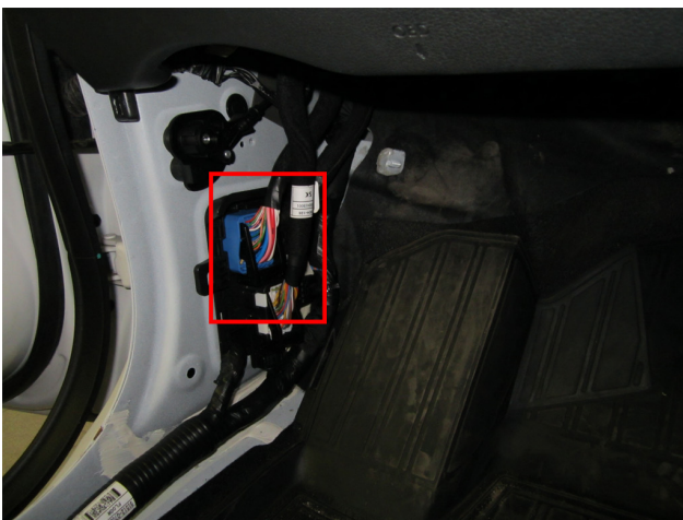
Рис.5 Место подключения к силовым цепям запуска двигателя
