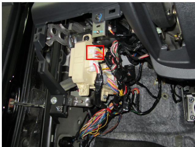
Рис.5 Место подключения к силовым цепям запуска двигателя
