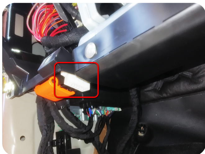
Подключение в белом 16-контактном диагностическом разъеме OBD II слева от рулевой колонки
