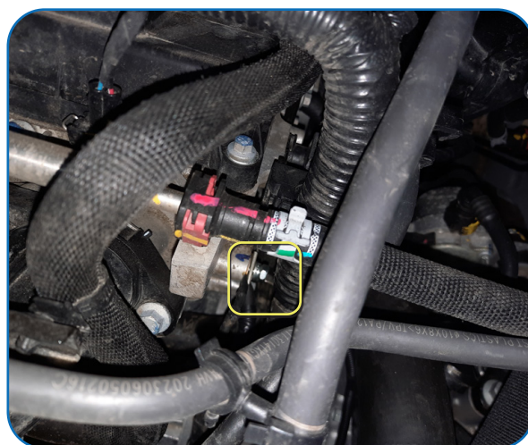
Примерное место размещения датчика температуры двигателя
