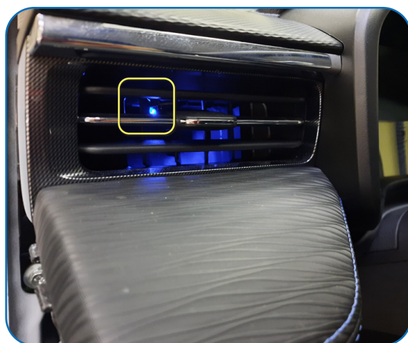
Примерное место размещения светодиода центрального блока
