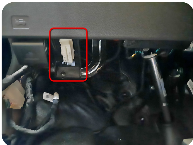
Подключение в белом 16-контактном диагностическом разьеме OBD II слева от рулевой колонки
